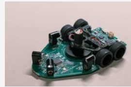
翠嵐3 宇都宮 正和 D-The-Star 公認記録 0:02.642 第三位 マイコン：RX系 サイズ：91x55x35 [mm] 35[g] 吸引機構あり
