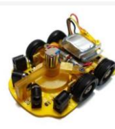
Spangle v5.1 徳永 弦久 KadoMakers/技術チャレンジ部 公認記録 0:04.914 第三位、ベストマウサー マイコン：RX系 サイズ：55x38x20 [mm] 17.5[g]
