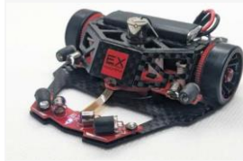
XM702 carmine 船田 健悟 Ex-machina 公認記録 0:02.100 優勝 マイコン：ARM系 サイズ：108x77x28 [mm] 78[g] 吸引機構あり
