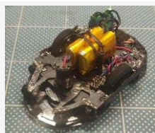
djtkuwaganon_act5E 高橋 良太 D-The-Star 公認記録 0:03.779 優勝 マイコン：RX系 サイズ：60x38x20 [mm] 20[g]
